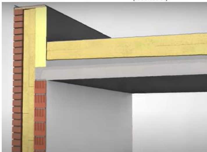
Detail dakrand en bakstenen gevelbekleding – links: houten dakstructuur, rechts betonnen dakstructuur
