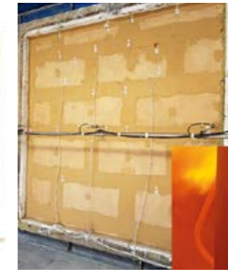
Leemplaat voor brandcompartimentering, met brandweerstand EI120, door producent Lemix, Duitsland.
